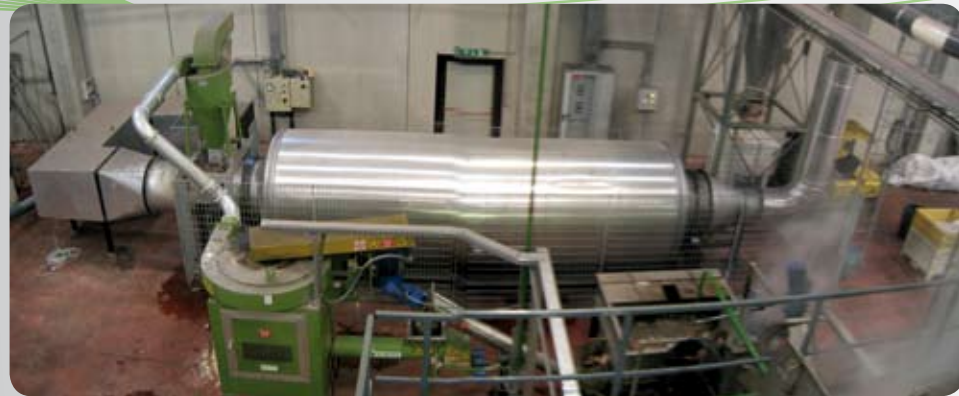
Essiccatore a tre passaggi con bruciatore a gas i "vena d'aria" Three steps dryer with gas burner
